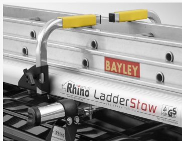
Montants de guidage réglables Hauteur réglable pour différents types d'échelles
